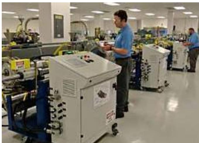
Razvijena optimizirana rješenja kod brtvljenja zahtjevaju sofisticirane ispitne i analitičke metodologije, zbog čega SKF posjeduje sopstvenu globalnu mrežu ispitnih stanica. Svake godine, ove vrhunske laboratorijske urede na hiljade testova, uključujući test izdržljivosti, performansi, isključivanje zagađivača, korozija u slanoj magli, hladni lomovi, sposobnost pumpanja, moment trenja, trošenja pri suhom režimu rada i hemijske podudarnosti.
