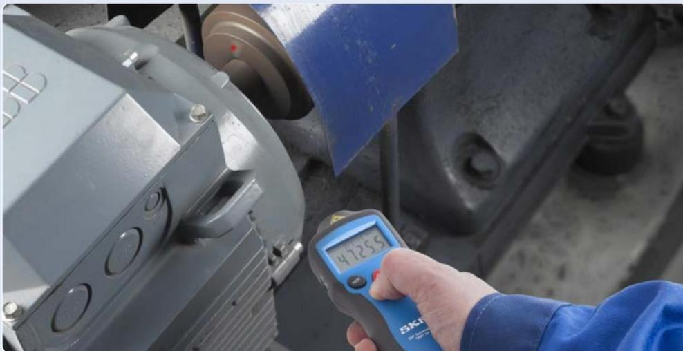
Mjerenje laserom omogućava lako i brzo mjerenje sa sigurne distance od rotacione opreme.
